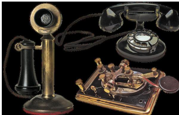
Abbildung 1: Telegraph und altes Telefon <sup>1</sup>
